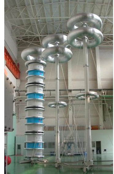
Резонансная система 1000 кВ / 6000 кВА Mitsubishi Electric
