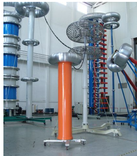
Образцовый конденсатор 400 кВ / 100 пФ
