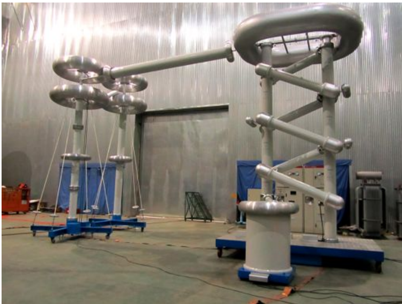
Испытательная система постоянного напряжения 800kV / 20mA HVTS company, France
